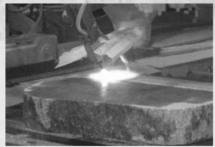
Flamming av overflater
