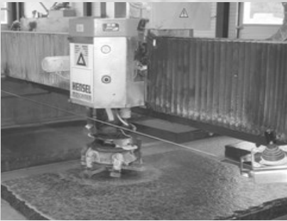
Polering og sliping av overflater
